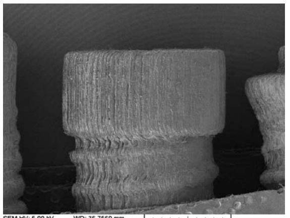
圖 6. MKIV 人工牙釘之 SEM 結構圖
